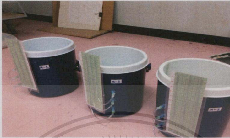
รูปที่ 3.8 แบบจำลองที่ติดตั้งพีโซมิเตอร์(1)
