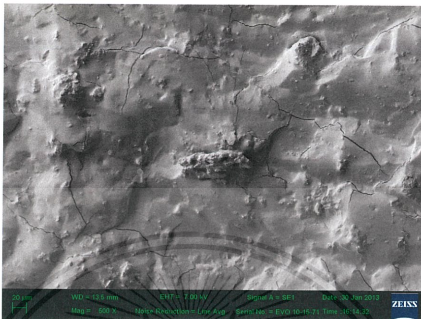
รูปที่ 4.23 สัณฐานวิทยาของยางธรรมชาติที่ใช้ผงหนังกขนาดระหว่าง 12-35 mesh ปริมาณ 30 phr กำลังขยาย 500 เท่า
