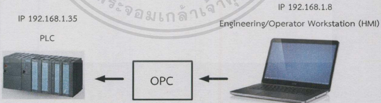
รูปที่ 3.40 การเชื่อมต่อ HMI ไปยัง PLC ผ่าน OPC
