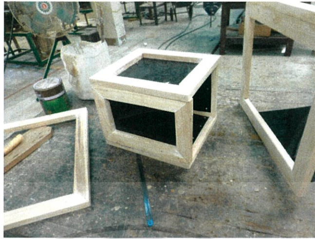
ภาพที่ หลังจากที่ยึดแผ่นอะคลิลิกลงบนไม้แล้ว นำมาประกอบกันด้วยตะปูลมและกาว
