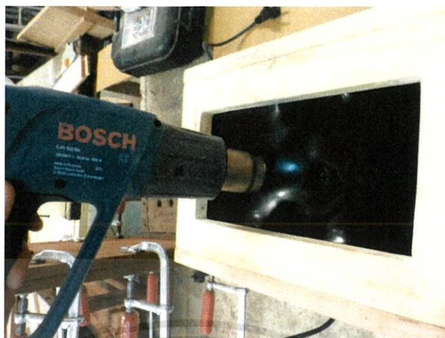
ภาพที่ 1 ภาพนำแผ่นอะคลิลิกที่ยึดลงบน โครงไม้เสร็จเรียบร้อยแล้วมาเป่าด้วยความร้อนให้ทั่วแผ่น
