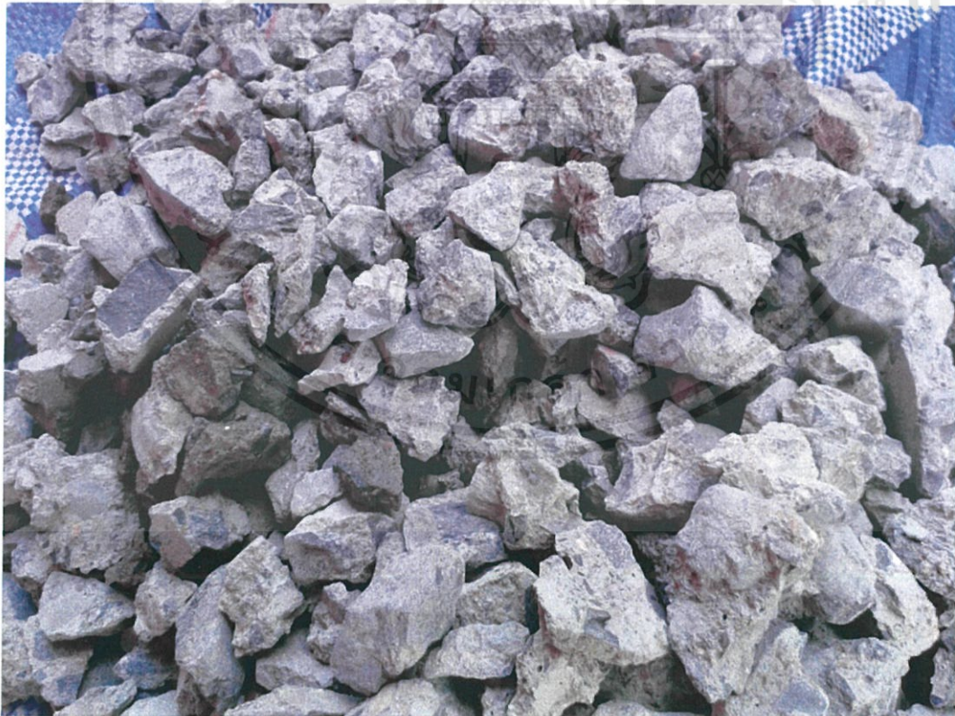
รูปที่ ข.2 วัสดุมวลรวมหายาที่ได้จากการย่อยเศษคอนกรีต
