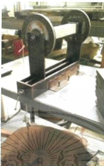
รูปที่ 3.12 การเตรียมทดสอบแรงบิดกับแบบจำลองคานคอนกรีตเสริมเหล็ก
