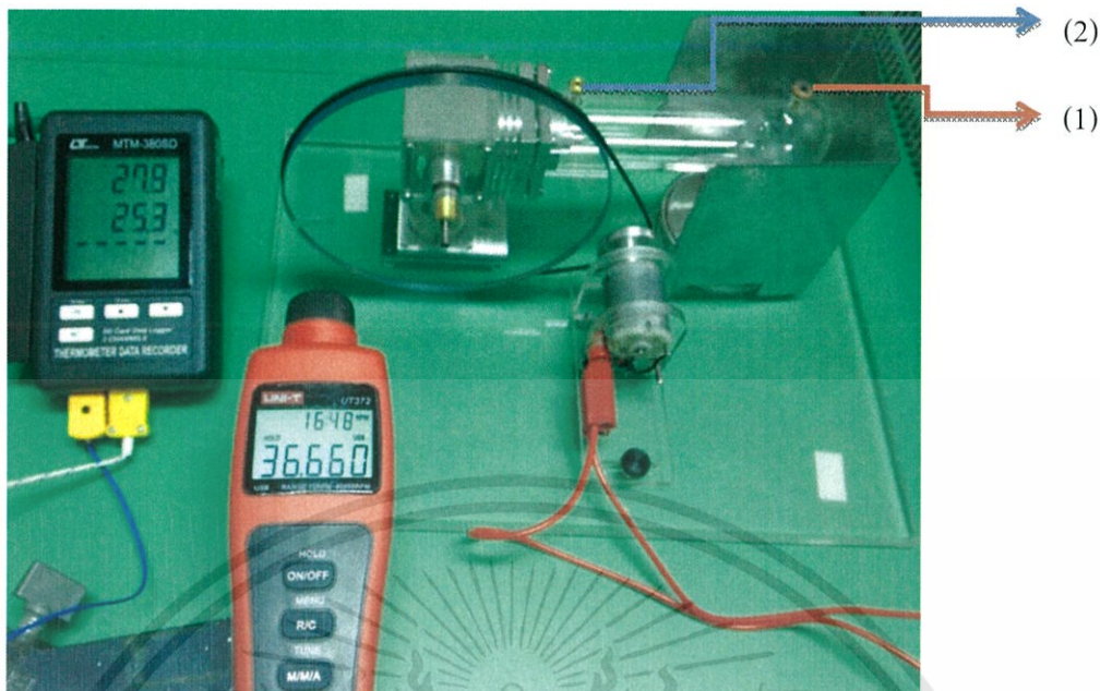
รูปที่ 3.18 การวัดความเร็วรอบและอุณหภูมิของเครื่องยนต์สเตอร์ลิง
