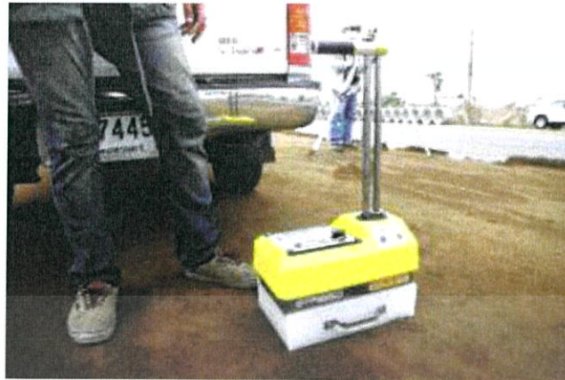
รูปที่ 2.4 การนำเครื่องทดสอบวางบนแผ่นบอล์คพาราฟินเพื่อทำ Standard count
