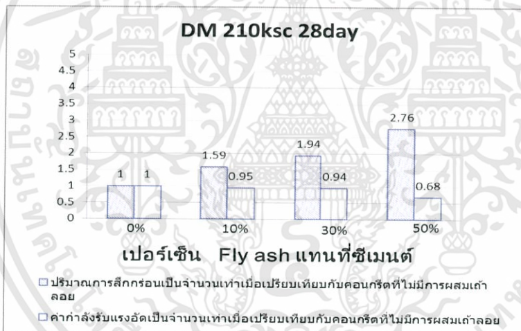
รูปที่ 4.27 แสดงปริมาณการสึกกร่อนของคอนกรีตเป็นจำนวนเท่าโดยเปรียบเทียบกับคอนกรีตที่ไม่มีการผสมเถ้าลอย ของคอนกรีตผสมแบบ DM กำลังอัด 210 ksc ที่อายุ 28 วัน
