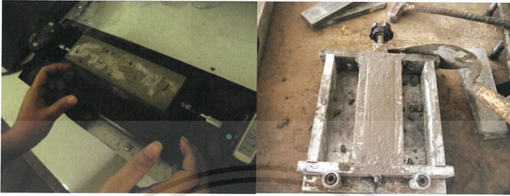
รูปที่ 3.12 แสดงการทดลองการหดตัวในซีเมนต์เพสต์ตามมาตรฐาน JIS A 1129
