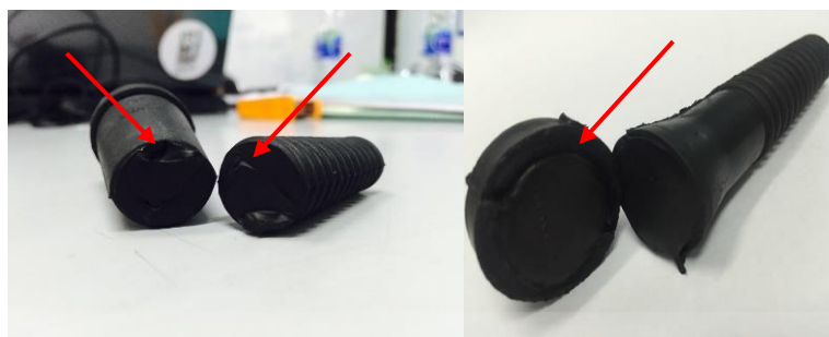
รูปที่ 1.2 ตัวอย่างการเสียหายของยางถอนขนสั้วปีกที่หักจากการพับงอ (แสดงดังลูกศร)
