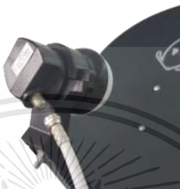
การต่อสายนำสัญญาณ RG6 กับหัว LNB
