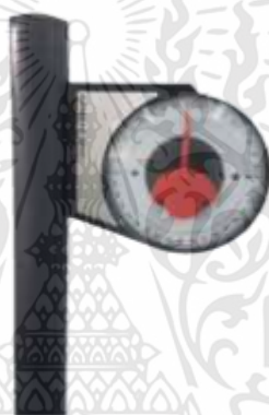
ภาพที่ ฅ.28 การติดตั้งเสาจานรับสัญญาณดาวเทียมให้ตั้งฉาก 90 องศา
