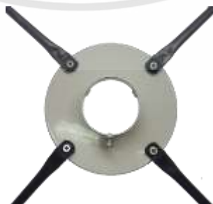
ภาพที่ ฅ.38 ประกอบแขนพีดกับสกาล่าร์ริง
