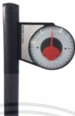
ภาพที่ ฅ.42 การติดตั้งเสาจานรับสัญญาณดาวเทียมให้ตั้งฉาก 90 องศา
