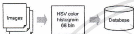
รูปที่ 4 กระบวนการคำนวณภาพเป็นฮิสโตแกรมสี
