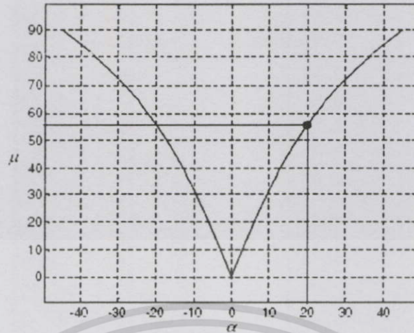
รูปที่ 2.14 ไคอะแกรมมุมกด (pressure angle) เคลื่อนที่ของ Geneva เมื่อ n = 4, b = 100 \text{ mm} .
