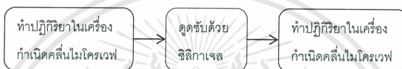
รูปที่ 3.1 ขั้นตอนการทำการทดลองโดยใช้เครื่องกำเนิดคลื่นไมโครเวฟ
