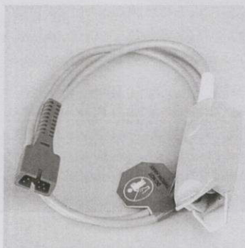
รูปที่ 2.16 แสดงขาตัวตรวจวัดความอิมิตัวออกซิเจนของฮีโมโกลบิน
