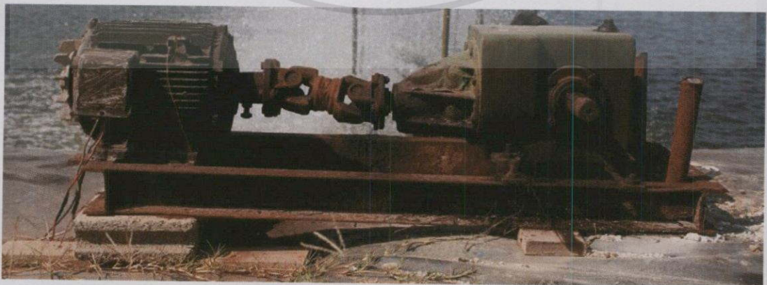
รูปที่ 4.30 มอเตอร์ใบพัดตีน้ำไฟฟ้าสามเฟส
