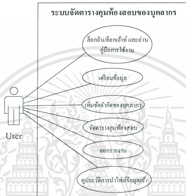
รูปที่ 3.6 Use Case Diagram ของระบบจัดการรวมห้องสอบของบุคลากร
