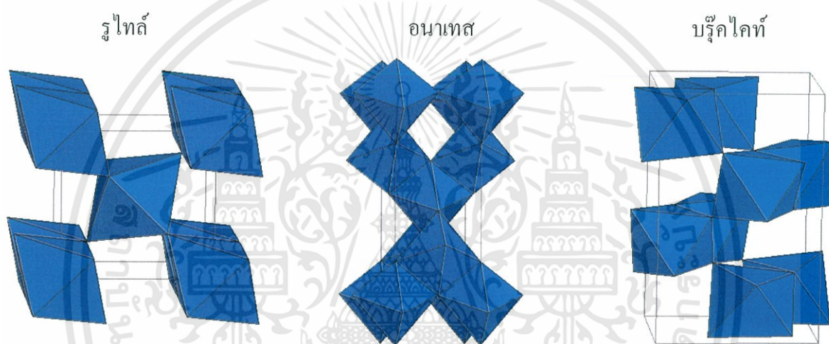
รูปที่ 2.3 โครงสร้างแบบผลึกของไทเทเนียม ไดออกไซด์ที่แตกต่างกันทั้งสามรูปแบบ
