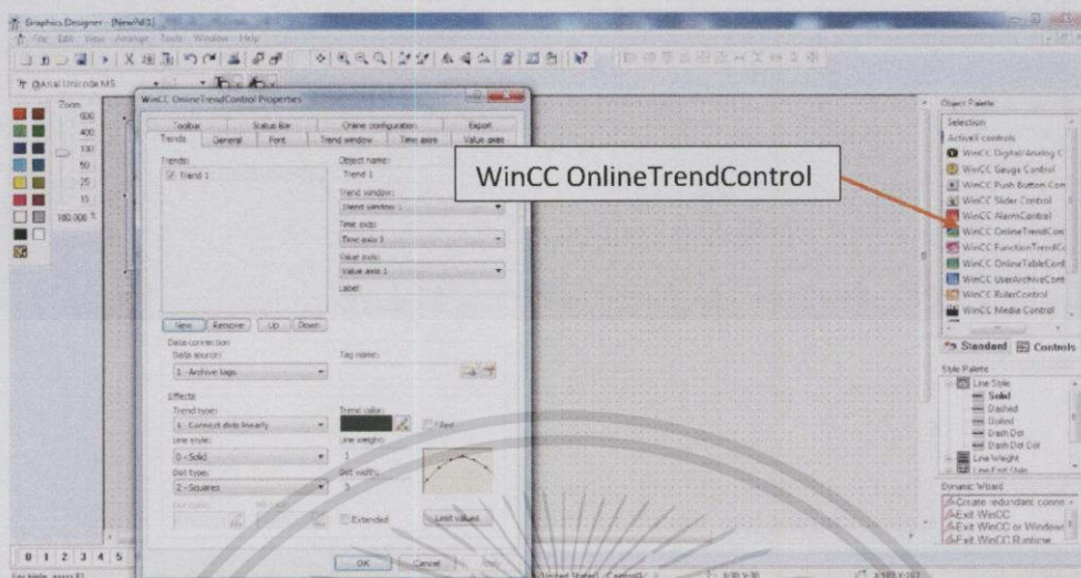
รูปที่ 3.21 หน้าต่างสำหรับเลือกใช้ WinCC OnlineTrendControl
