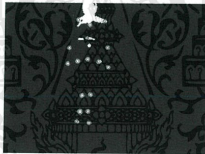
รูปที่ 4.13 ทำการ Hough Circle จะได้พิกัด 2D มาร์กเกอร์
