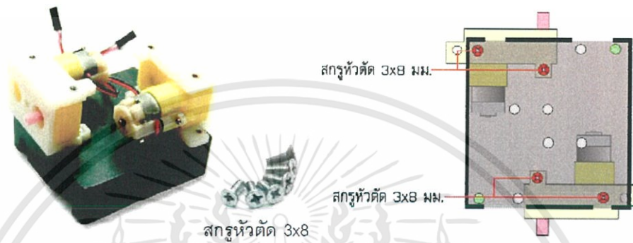
รูปที่ 3.44 ยึดมอเตอร์เข้ากับกระเบาะถ่าน
