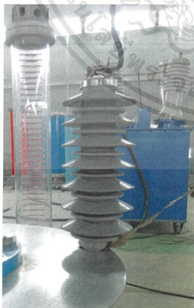
รูปที่ 3.24 กับดักฟ้าผ่า พิกัดกระแส 5 kA
