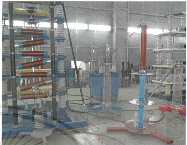
รูปที่ 6 วงจรทดสอบเครื่องกำเนิดกระแสอิมพัลส์ช่วงยาว
