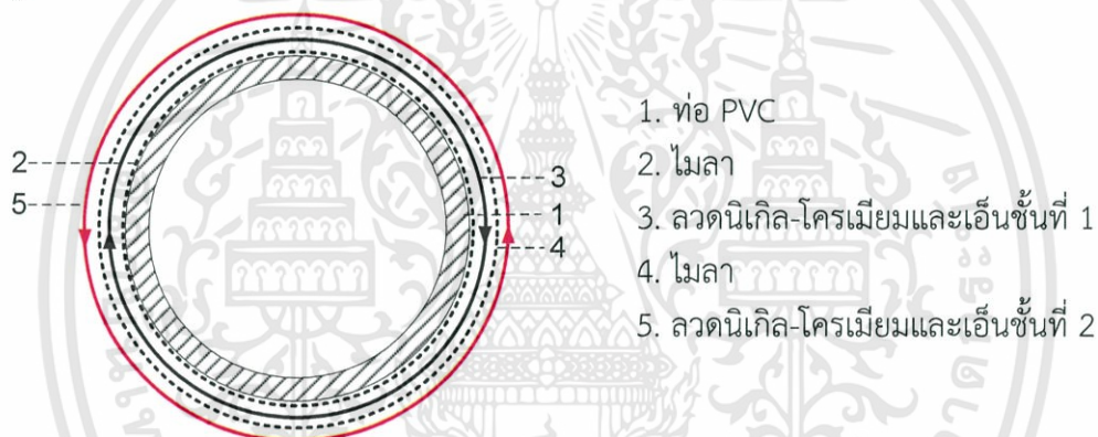
รูปที่ 3.9 ภาพตัดขวางของการพันความต้านทานแม่เหล็ก
