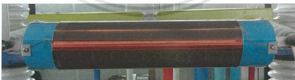
รูปที่ 3.20 ความเหนี่ยวนำ L_3 - L_6 ขนาด 6.5 mH
