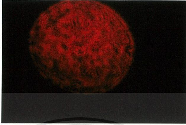
รูปที่ 4.3 แสงเลเซอร์ไม่เกิดการแทรกสอดกันเมื่อพ้นจากระยะความยาวโคฮีเรนซ์
