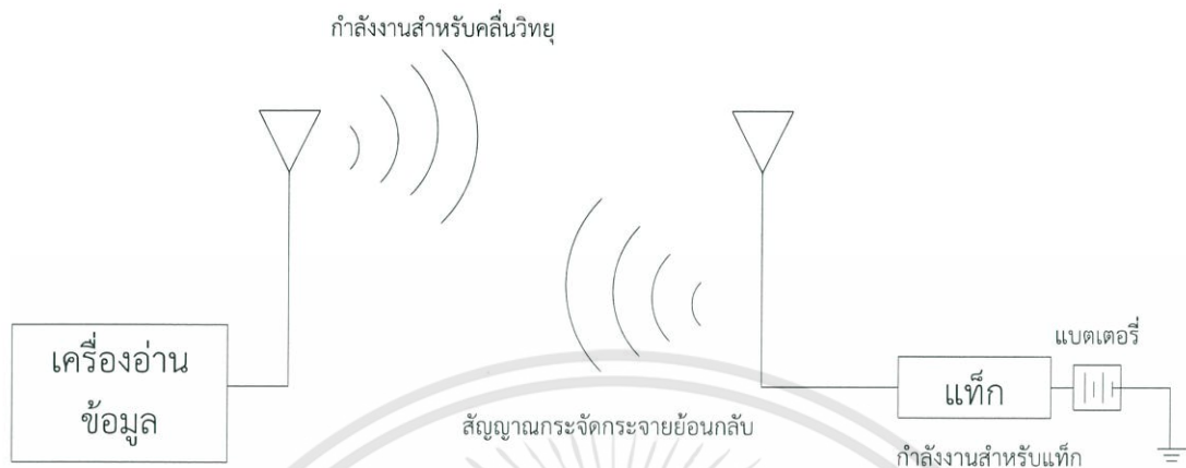
รูปที่ 2.7 หลักการทำงานของแท็กชนิดกึ่งแอ็กทีฟ
