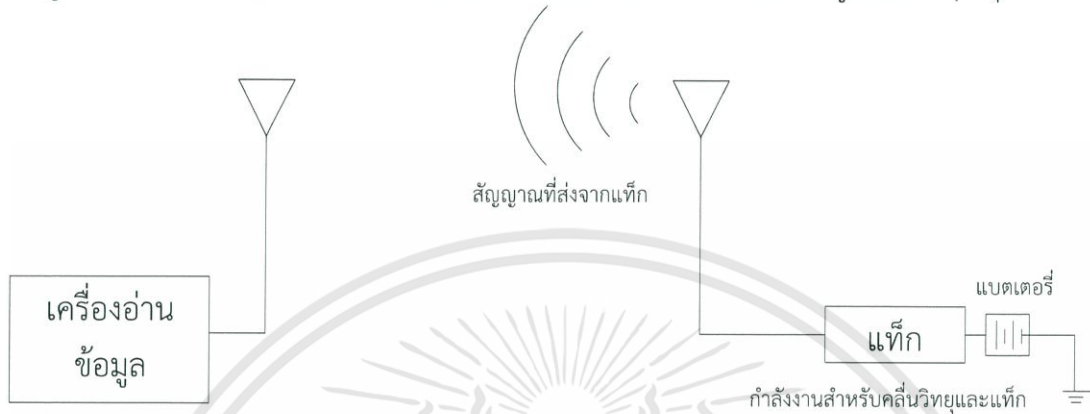
รูปที่ 2.5 หลักการทำงานของแท็กชนิดแอ็กทีฟ
