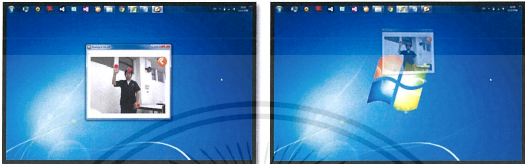
รูปที่ 4.25 ภาพแสดงการย่อหน้าต่างเก็บไว้เมื่อผู้ใช้ยกมือซ้าย
