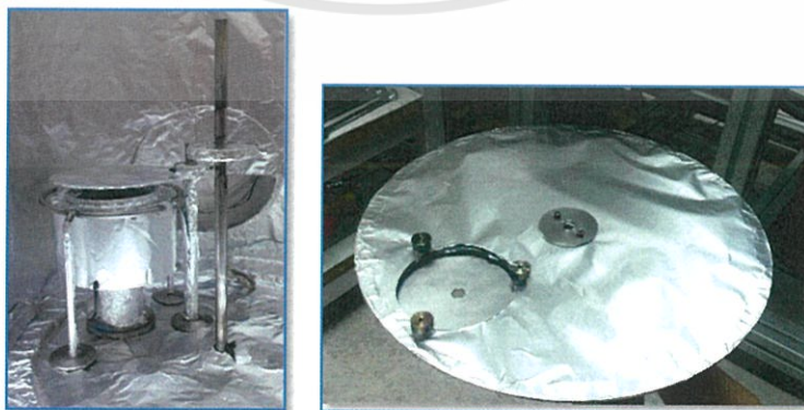
รูปที่ 3.12 อุปกรณ์ที่ห่อฟอยล์อลูมิเนียมและติดตั้งในแชมเบอร์สุญญากาศเรียบร้อยแล้ว
