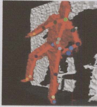
รูปที่ 2.5 แสดงข้อต่อที่ตัวรับสัญญาณวิเคราะห์ได้
