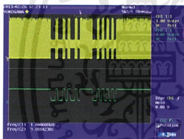
รูปที่ 14 สัญญาณข้อมูลจากสายส่งกำลังที่จุด A และ B
