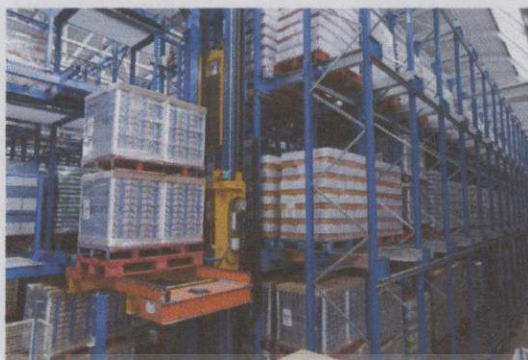
รูปที่ 2.15 ระบบการจัดเก็บและค้นหาแบบอัตโนมัติ (ASAR)
