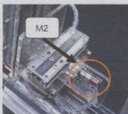
รูปที่ 3.25 มอเตอร์ไฟฟ้าควบคุมฟอล์คลิฟต์
