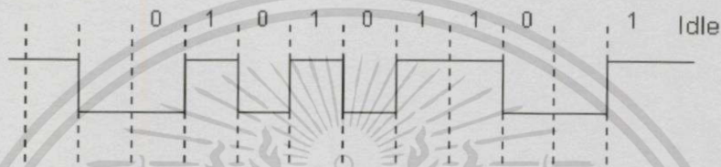
รูปที่ 2.10 การสื่อสารแบบอะซิงโครนัสที่ใช้พาริตีบิต
