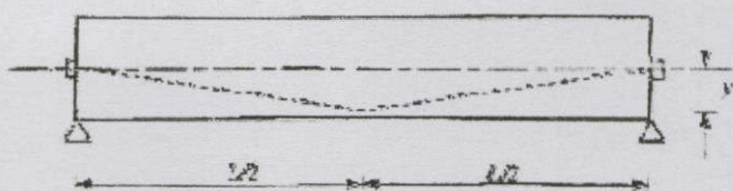
รูป 4.4 คานกอนกรีตอัดแรงที่มีแนวเหล็กเสริมแรงหักมุมตรงกึ่งกลางช่วงคาน
