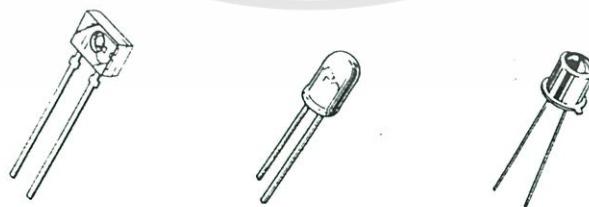
รูปที่ 2.1.6 แสดงลักษณะภายนอกของไดโอดเปล่งแสงแบบต่างๆ
