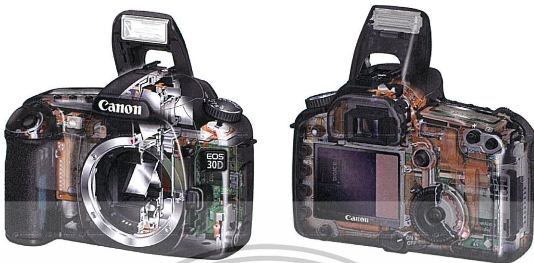
รูปที่ 3.2 โครงสร้างองค์ประกอบภายในตัวกล้อง DSLR ยี่ห้อ CANON รุ่น EOS 30D [15]
