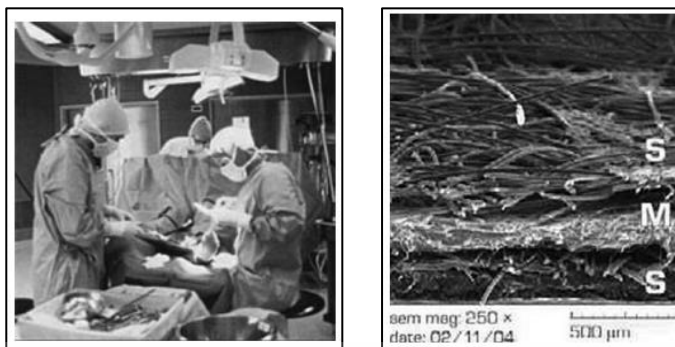
ภาพที่ 2.49 ชุดผ้าตัดแพทย์ทำจากนอนวูฟเวนแบบสปันบอนด์-เมลต์โบลน-สปันบอนด์ ที่มา : จุรีรัตน์ ประसार ( 2552 : 25 )
