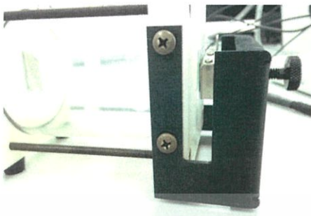
รูปที่ 3.11 ยึดฟิล์มบางไทเทเนียมไนไตรด์ในชุดเซลล์
