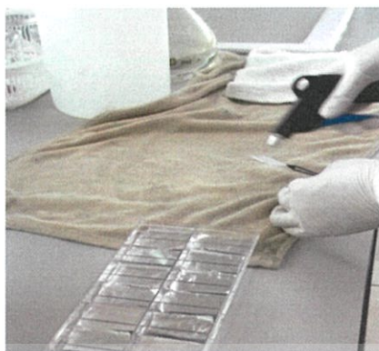
รูปที่ 3.6 เป่าแผ่นซิลิกอน โดยใช้ก๊าซไนโตรเจน
