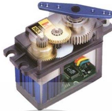
รูปที่ 1.1 แสดงโครงสร้างเซอร์โวมอเตอร์
