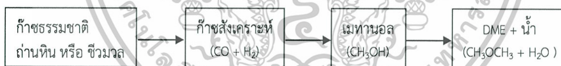
รูปที่ 2.4 การผลิตแบบทางอ้อมโดยผ่านกระบวนการดีไฮเดรชันของเมทานอล [6]
