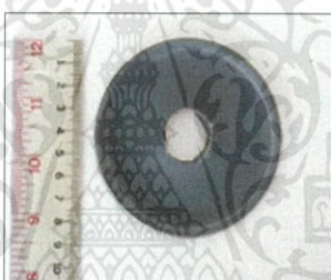
รูปที่ ข-3 แผ่นยางผสมไทเทเนียมไดออกไซด์ที่เติมท่อนาโนคาร์บอน 2 มิลลิกรัม
