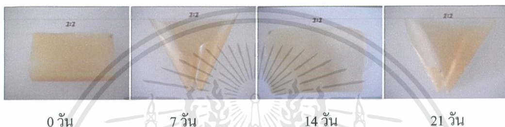
รูปที่ 4.6 การดูดซับน้ำของฟิล์มจากแป้งกล้วยที่ปรับปรุงด้วยพอลิไวนิลแอลกอฮอล์ และเพคติน ในอัตราส่วน 1:1
