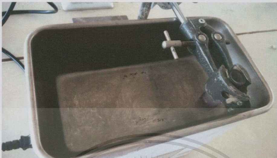
รูปที่ 3.2 ทำการแพร่กระจายฟูลเลอร์ในสารละลายไคคลอโรมีเทน ด้วยเครื่อง Ultrasonic Sink
