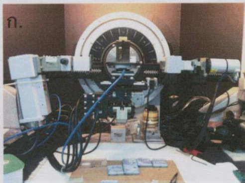
รูปที่ 3.3 ก. การวางตัวของแหล่งกำเนิดรังสีเอกซ์ ฐานรองชิ้นงาน และตัวตรวจจับ
