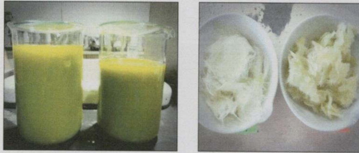
รูปที่ 4.2 ตัวอย่างน้ำกาวที่ได้จากการสกัด PVC (Plastisol) และเส้นใยแก้วหลังการสกัดด้วยตัวทำละลาย
