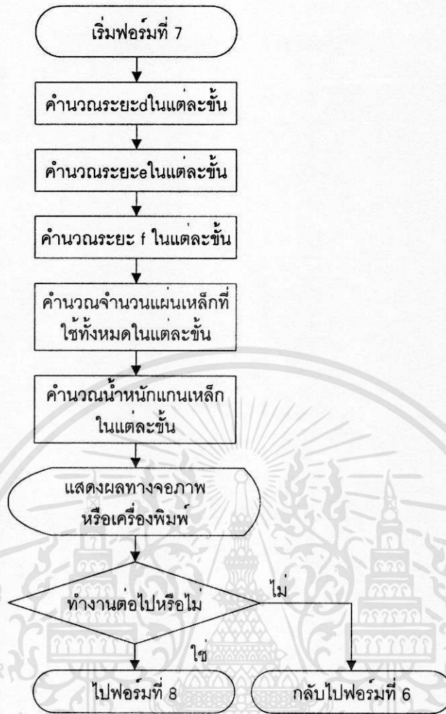
ภาพที่ 4.7 แสดงขั้นตอนการทำงานของซอฟต์แวร์ฟอร์มที่ 7 การคำนวณหาขนาดขาของแกนเหล็ก (Center Limb)
