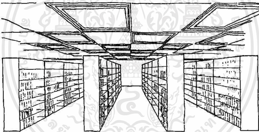
ภาพที่ 2.39 แสดงการให้แสงสว่างในระบบตาราง (Grid pattern)
