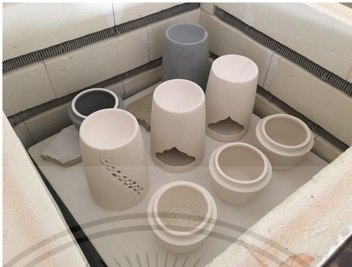
ภาพที่ ฉ.9 ชุบเคลือบ และนำไปเผา 1200 c ภาพโดย : ศศิประภา เวชศิลป์
