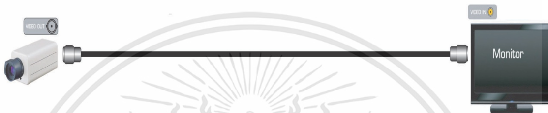
ภาพที่ 2.1 กล้องกับจอแสดงผล (Monitor) เชื่อมต่อกันโดยตรง ที่มา : ( http://www.mediasearch.co.th/News-CCTV-FUJIKO12.html )
