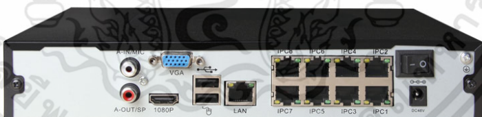
ภาพที่ 2.11 เครื่องบันทึกวิดีโอบนระบบเครือข่าย (Network Video Recorder, NVR)
