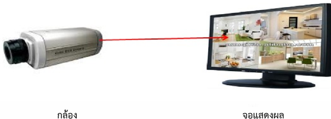
ภาพที่ ซ.1.5 กล้องส่งสัญญาณไปที่จอแสดงผล (Monitor) ระบบนี้ไม่มีการบันทึกภาพ ที่มา : ( http://www.mediasearch.co.th/News-CCTV-FUJIKO12.html )
