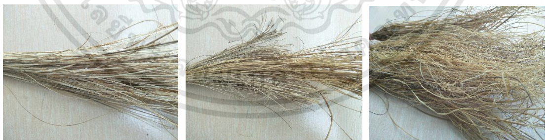
ภาพที่ 4.13 ลักษณะเส้นใยกาบหมากที่หมักด้วย น้ำเปล่า น้ำ กรดอะซิติก และโซเดียมไฮดรอกไซด์ ภาพโดย : ณัชชา ศรีวิจิตร (ถ่ายเมื่อ 4 กันยายน พ.ศ.2561)
