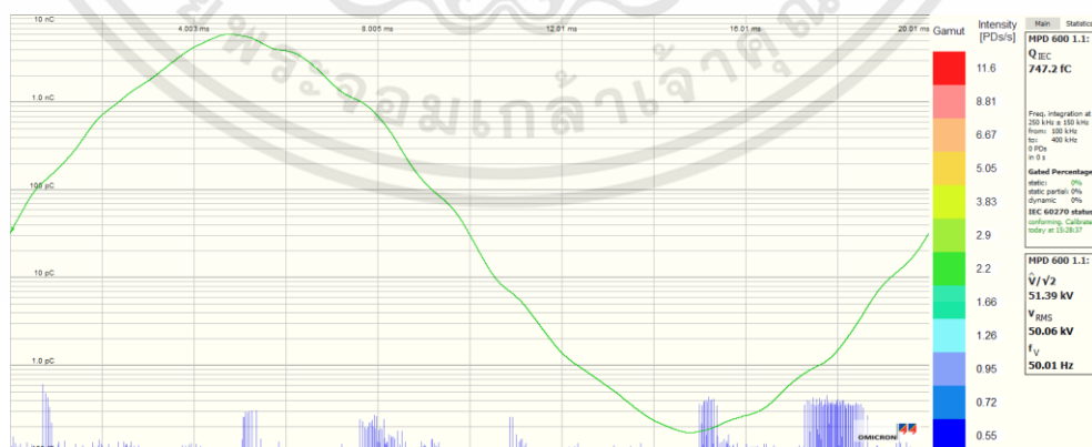
รูปที่ 4.5 ผลการทดสอบการตรวจจับการเกิดการดิสชาร์จบางส่วนของตัวเก็บประจุเฟส C ที่แรงดันพิกัด 50 kV rms (ค่าประจุสูงสุด 747.2 fC ที่ 50.06 kV RMS )
