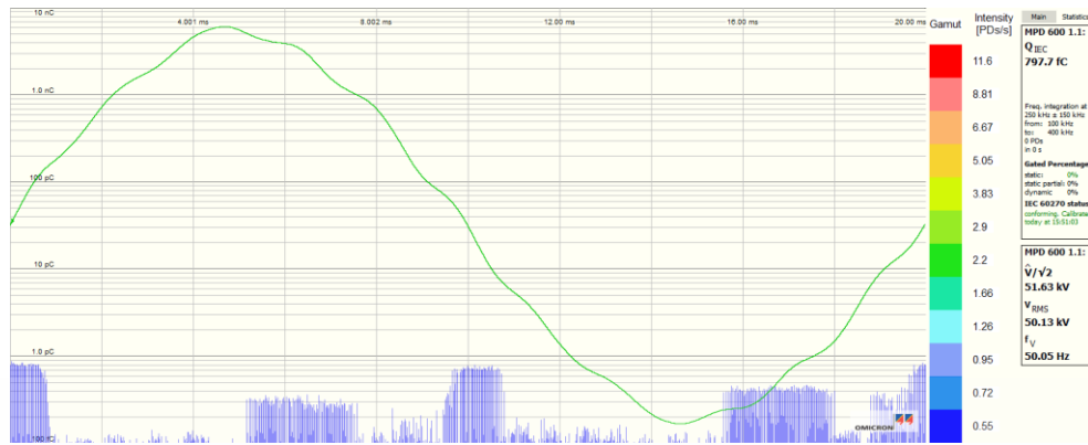
รูปที่ 4.3 ผลการทดสอบการตรวจจับการเกิดการดิสชาร์จบางส่วนของตัวเก็บประจุเฟส A ที่แรงดันพิกัด 50 kV rms (ค่าประจุสูงสุด 797.7 fC ที่ 50.13 kV RMS )
