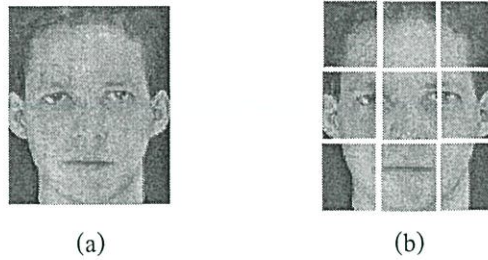
ภาพที่ 2.2 ภาพตัวอย่างการแบ่งรูปภาพใบหน้าเป็น 9 รูปภาพใบหน้าที่ย่อ
