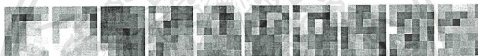
ภาพที่ 4.14 ตัวอย่าง Eigenface ของ LL Subband ที่ประมวลผลด้วยกระบวนการ Wavelet Transform ลำดับที่ 4 เมื่อทำการทดลองกับฐานข้อมูลรูปภาพใบหน้าของ UMIST
