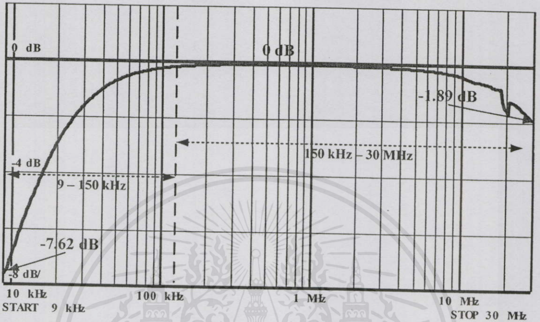
รูปที่ 6.15 ค่าการสูญเสียเนื่องจากการใส่แทรกทางด้านนิวัตกรอลของ LISN ที่นำเสนอ ในย่านความถี่ 9 kHz - 30 MHz
